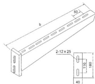
TB-03型托臂与H-01D型钢立柱、H-01C型钢立柱直接在墙壁型上装。
