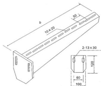
TB-01B托臂一般用膨胀螺栓与墙壁等直接安装或钢件焊接，也可配上压板与TB-01A工字钢配套安装。
