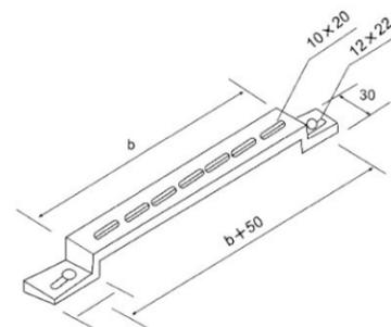
TB-04型托臂适用于各种形式桥架在垂直引上、引下或过梁时固定用。
